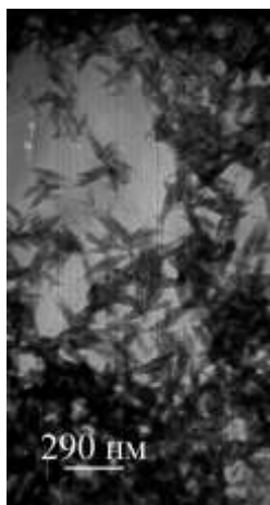
Рис. 1. Светопольное изображение частиц наноразмерного гидроксилапатита, полученное при помощи просвечивающего электронного микроскопа JEM2100 фирмы JEOL.
