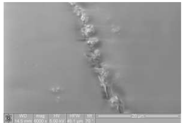
Рис. 3. Увеличенное изображение фрагмента одной из трещин, покрытой лаком «Нанофлюор»
